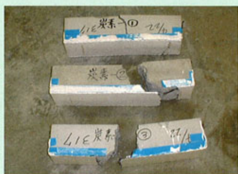
さらに荷重をかけ続けると②、③のように破断 (母材破断)。
