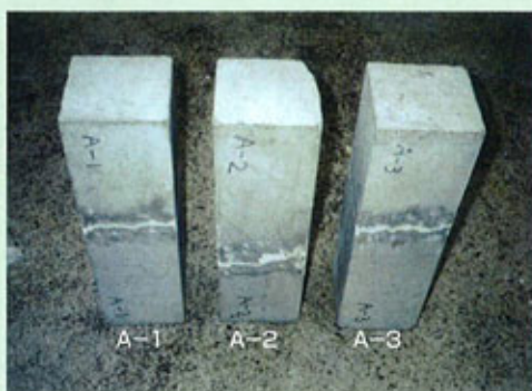
破断部分にクリスタルライニング材で接着。
