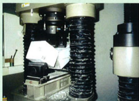
接着させた箇所以外から破断。
